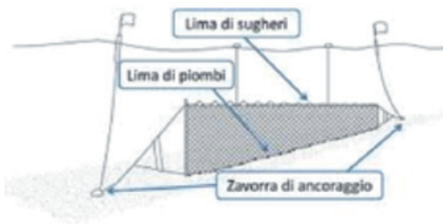
Figura 9 - reti ad imbocco
